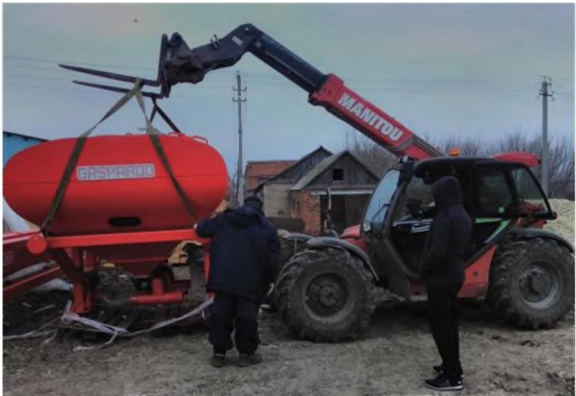
Рис. 17. Отряд «Агроинженер». Сборка и настройка посевного комплекса Gaspardo для ООО «Мировая техника».
