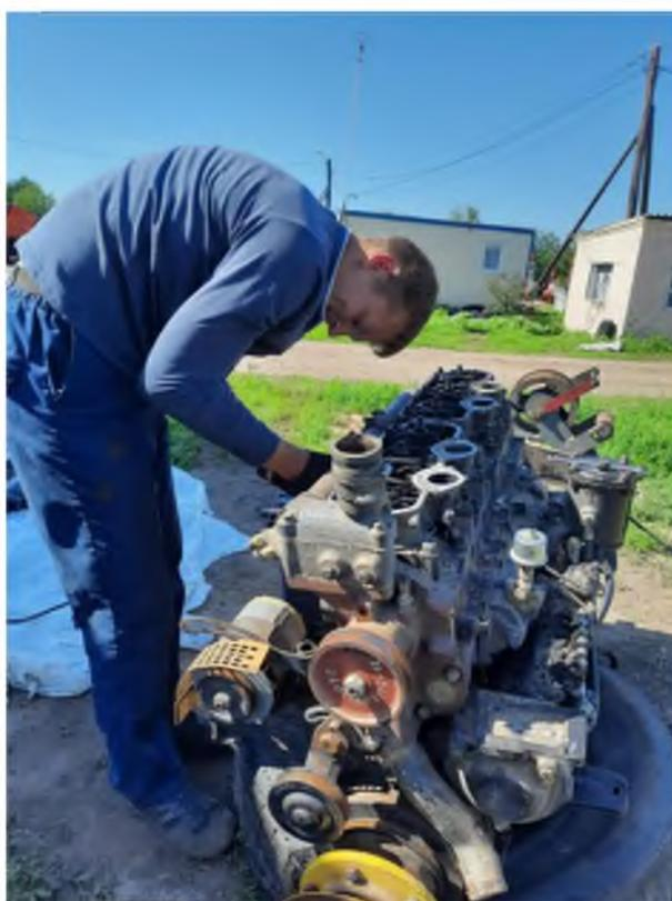
Рис.2. Отряд «Агроинженер». Боец отряда проводит разборку двигателя Д-260 на машинном дворе УНПО «Поволжье».
