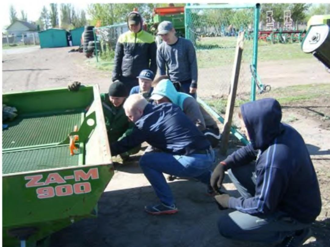
Рис.8. Отряд «Агроинженер». Бойцы отряда под руководством доцента кафедры «Техническое обеспечение АПК» Данилина А.В. проводят настройку разбрасыватель минеральных удобрений Amazone.
