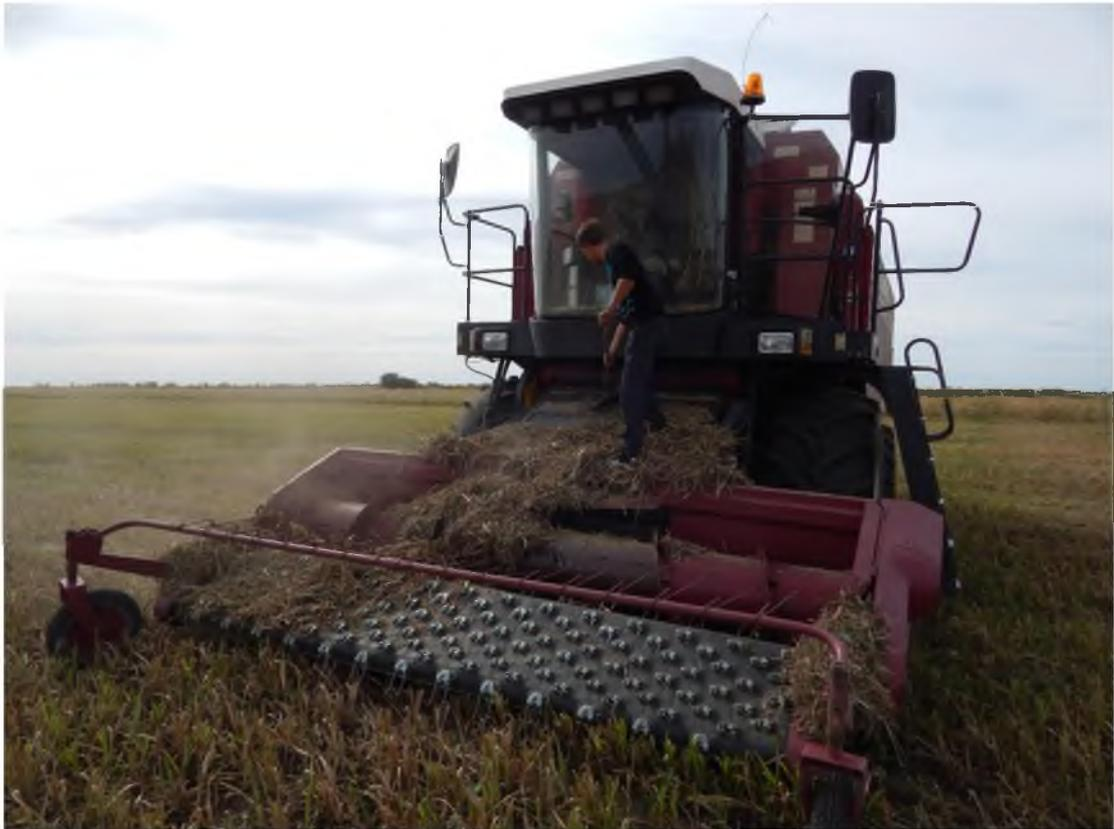
Рис. 12. Отряд «Агроинженер». Очистка наклонной камеры комбайна «Полесье GS812» в полевых условиях
