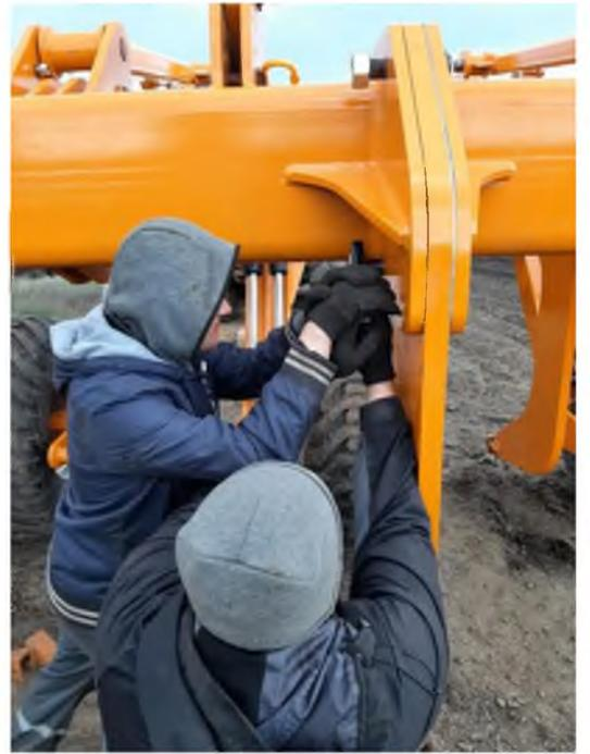
Рис.5. Отряд «Агроинженер». Бойцы отряда производят замену рабочих органов энергетической техники.
