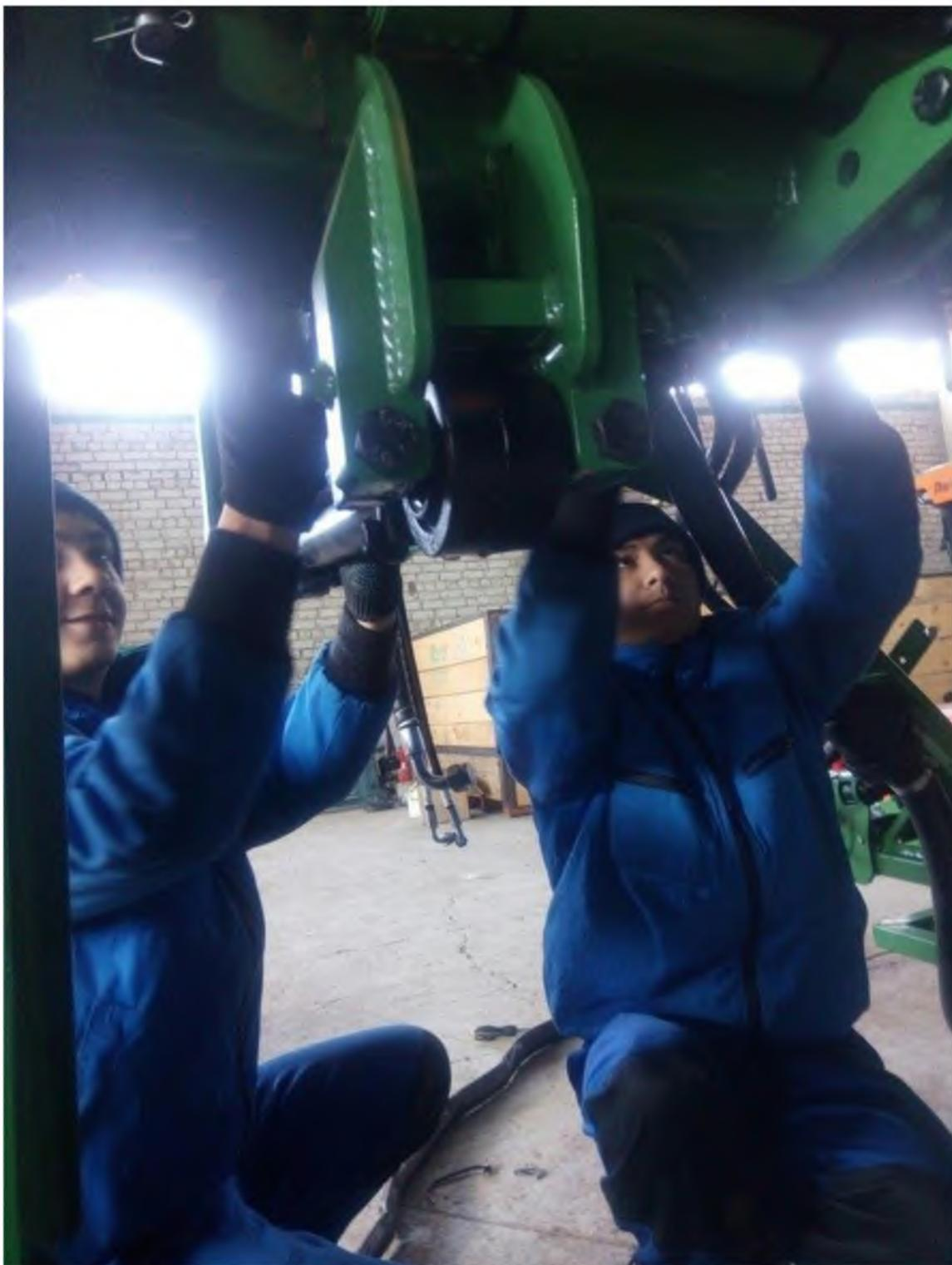
Рис. 15. Отряд «Агроинженер». Бойцы отряда монтируют ходовую часть и трансмиссию самоходного опрыскивателя STARA IMPERADOR 3100 на производственной площадке ООО «Мировая техника».
